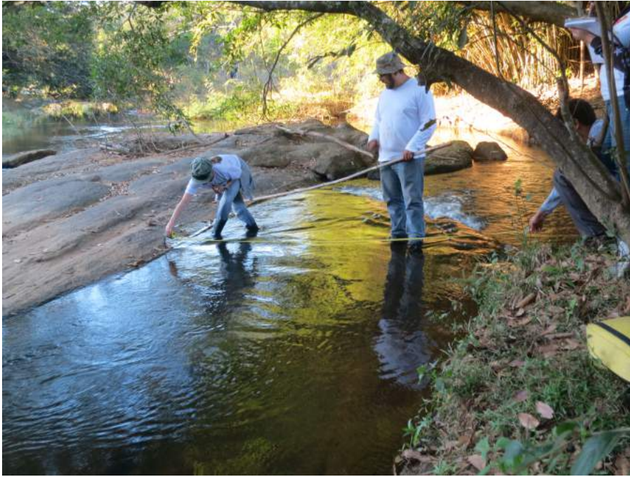
FIGURA 27: TREINAMENTO DOS ALUNOS NA DETERMINAÇÃO DA VAZÃO NO TRECHO DO RIO MACAPÁ EM SÃO FIDÉLIS
