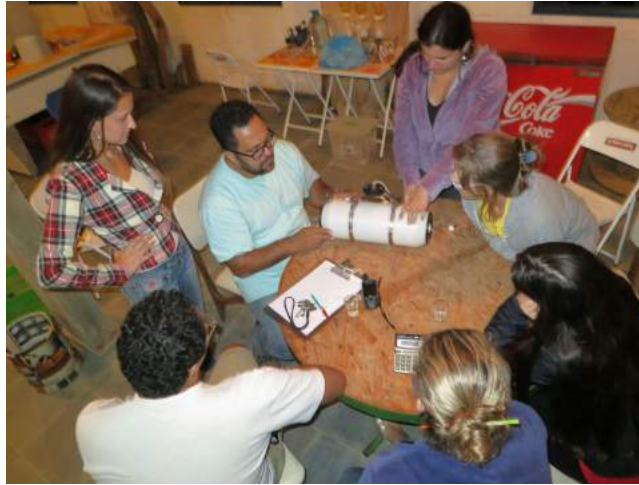
FIGURA 5: EXPLICAÇÃO SOBRE A UTILIZAÇÃO DA GARRAFA DE VAN DORN.
