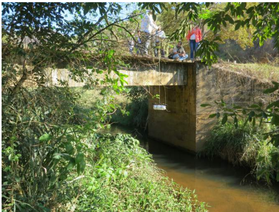
FIGURA 22: UTILIZAÇÃO DA GARRAFA DE VAN DORN PARA COLETA DE AMOSTRAS DE ÁGUA..
